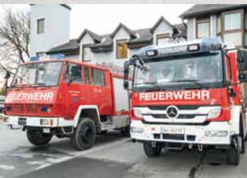
Das über 34 Jahre im Dienst stehende TLFA Steyr 1291 konnte durch ein modernes Einsatzfahrzeug, TLFA 2000/200, Mercedes Atego 1629, ersetzt werden.
